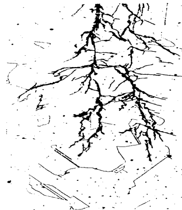
Gambar 1. Retakan korosi tegangan pada stainless steel (Fontana, 1987)
